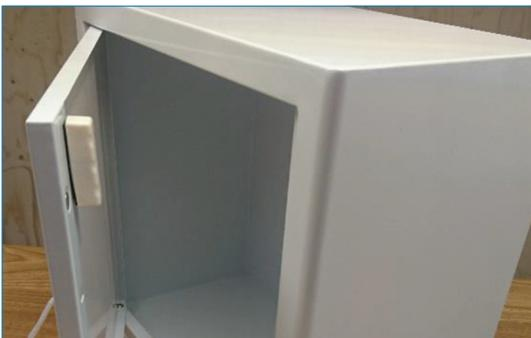
4. Das Alarmmodul auf «EIN» schalten, um den Alarm zu testen. Anschliessend die Türe schliessen, so dass sich der Alarm automatisch ausschaltet.
