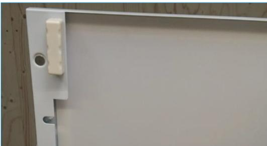
3. Der Abstand zwischen Alarm und Magnet darf nicht mehr als 10 mm betragen. Den Magneten so nah wie möglich am Alarm montieren und 10 Sekunden gedrückt halten für optimale Haftung.
