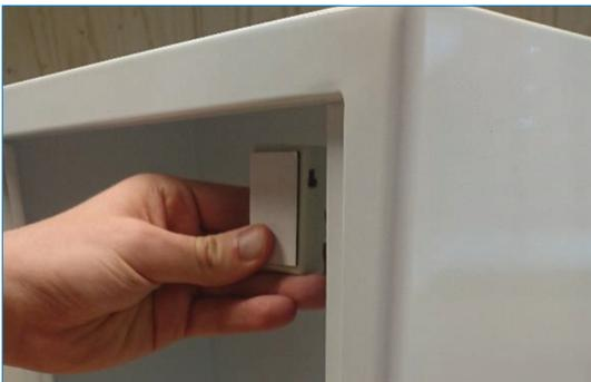
2. Schutzfolie vom Klebeband auf der Rückseite des Alarms entfernen. Alarm in der oberen rechten Ecke des Schrankes mit dem EIN-/AUS-Schalter nach rechts (siehe Foto) platzieren. Sicherstellen, dass der Alarm möglichst links am Rahmenrand zu liegen kommt, damit genügend Platz für die Bedienung des Schalters vorhanden ist.
